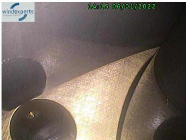
IMS Welle, Lager Rotorseite bedingt einsehbar, unauffällig.
