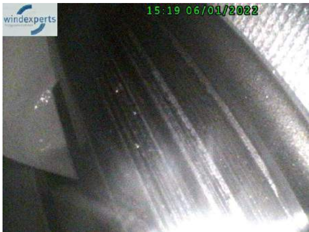
2 Planetenrad, Lastflanken zum Hohlrad mit schmalen Linien mit leichter Graufleckigkeit mittig und im Zahnfuß.
