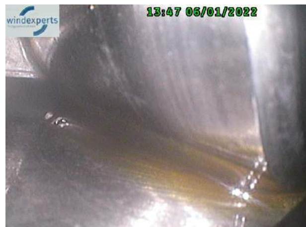
HSS Welle kleine Generastorstufe, Lager Rotorseite nur bedingt einsehbar = i.O
