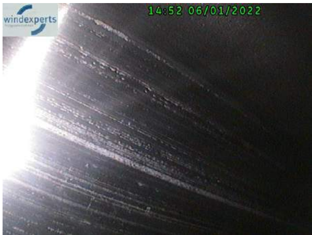
1 Planetenrad, Lastflanken zum Sonnenrad, Linien mit Graufleckigkeit im Zahnfuß
