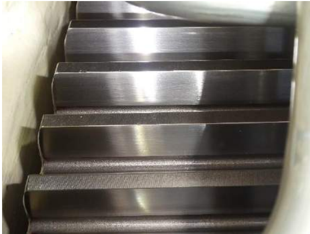
Rad langsame Welle, Lastflanken i.O.
