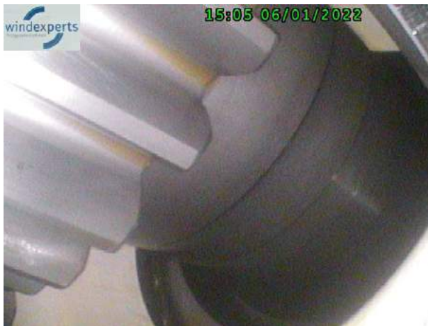
Sonnenrad, Lastflanken keine Auffälligkeiten.
