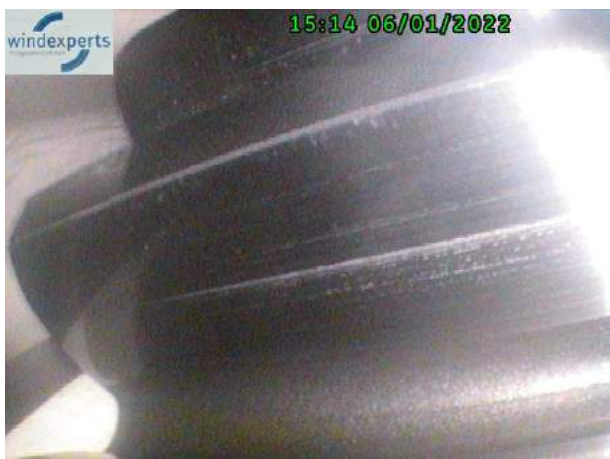
2 Planetenrad, Lastflanken zum Sonnenrad mittig mit schmalen Linien mit leichter Graufleckigkeit = i.O
