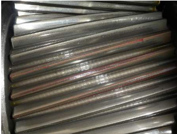
Ritzel HSS Welle, Lastflanken in der mitte, Graufleckigkeit im Zahnfuß und Kratzer von Fremdkörpern, teilweisen Ausbrüchen.
