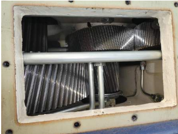
Übersicht Verzahnung der Stirnradstufe
