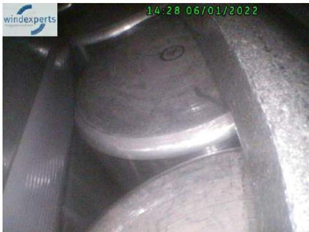
IMS Welle, Lager Generatorseite zweireihig, bedingt einsehbar, unauffällig.
