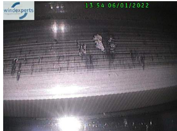
Ritzel HSS Welle, Lastflanken in der mitte, Graufleckigkeit im Zahnfuß und Kratzer von Fremdkörpern, teilweisen Ausbrüchen.
