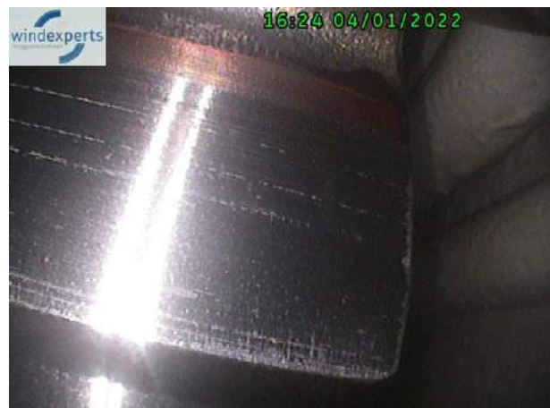
Ritzel HSS Welle, Lastflanken Graufleckigkeit im Zahnfuß und seitlich an der Generatorseite ohne Ausbrüche (Pittings) und Kratzer von Fremdkörpern.
