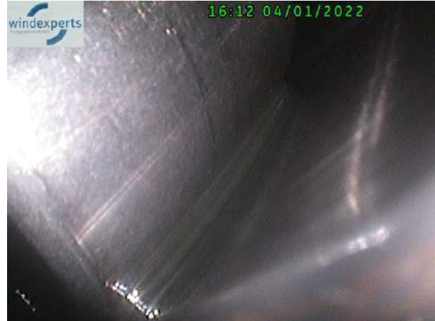
HSS Welle kleine Generatorstufe, Lager Rotorseite nur bedingt einsehbar, keine Auffälligkeiten.
