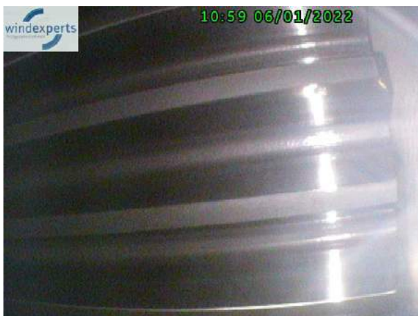
Sonnenrad, Lastflanken keine Auffälligkeiten.
