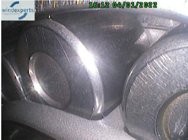
HSS Welle kleine Generatorstufe, Lager Rotorseite nur bedingt einsehbar, keine Auffälligkeiten.
