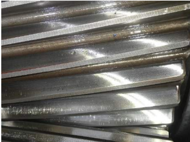
Ritzel HSS Welle, Lastflanken Graufleckigkeit im Zahnfuß und seitlich an der Generatorseite ohne Ausbrüche (Pittings) und Kratzer von Fremdkörpern.
