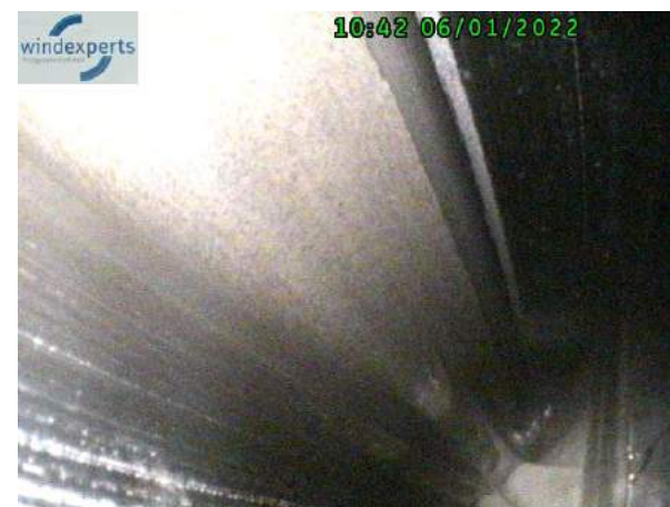
1 Planetenrad, Lastflanken zum Hohlrad mit schmale Linien mit Graufleckigkeit im Zahnfuß
