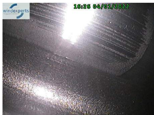
Ritzel IMS Welle, Lastflanken Graufleckigkeit im Zahnfuß und seitlich an der Generatorseite ohne Ausbrüche (Pittings)
