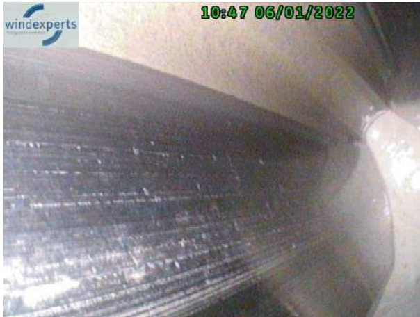
1 Planetenrad, Lastflanken zum Sonnenrad= i.O
